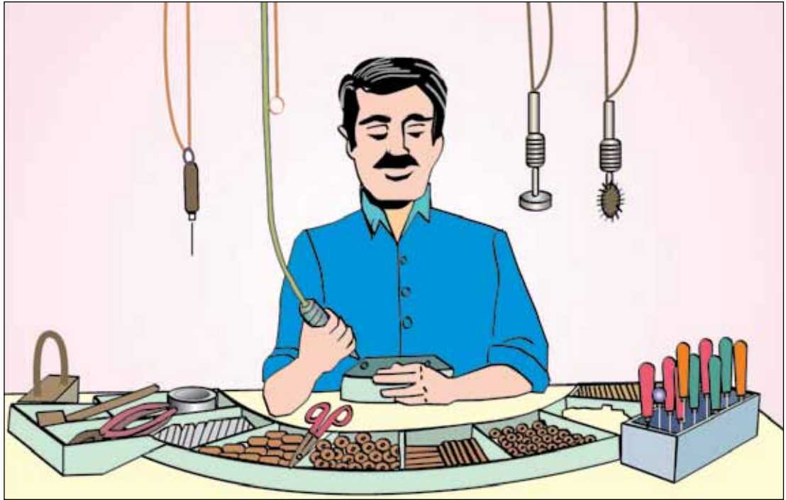
Figura 54. Situe os materiais, ferramentas e controles utilizados com mais frequência em uma área de fácil alcance.
