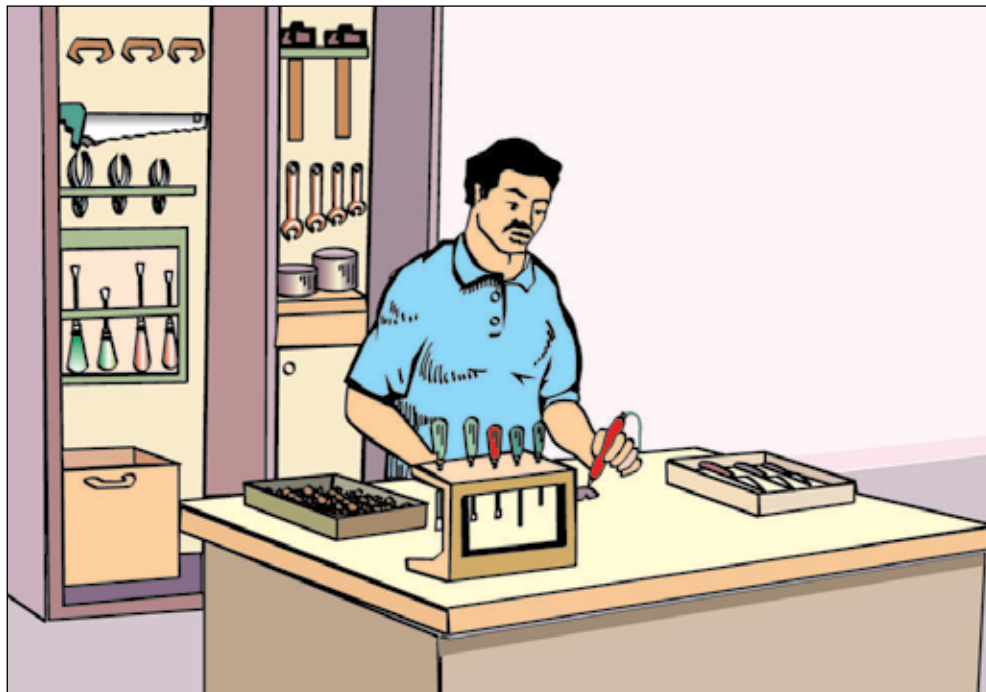
Figura 28c. Arrume lugares junto do trabalhador para as ferramentas que sejam repetidamente utilizadas. Os lugares das ferramentas que forem menos utilizadas podem estar nas proximidades do posto de trabalho.
