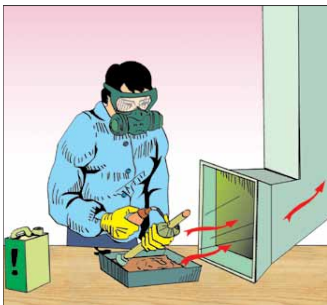
Figura 92a. Vapores nocivos podem ser puxados para dentro de um sistema de exaustão local, a fim de impedir que o trabalhador seja exposto a perigos químicos.
