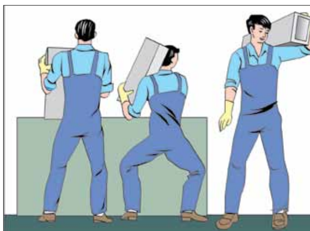
Figura 15d. Levantamento de cargas pesadas de uma plataforma na frente do corpo com o uso da força das pernas. O levantamento a partir de uma plataforma é melhor do que levantar a partir do chão.
