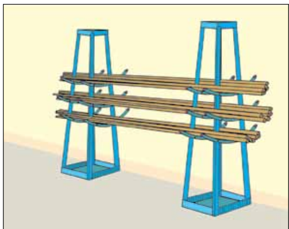
Figura 8b. Suporte de barra horizontal. Este modelo, colocado de pé livremente, sem necessidade de fixação, pode ser usado separadamente para armazenar pequenas peças, ou conjuntamente em linha para armazenar as peças maiores.
