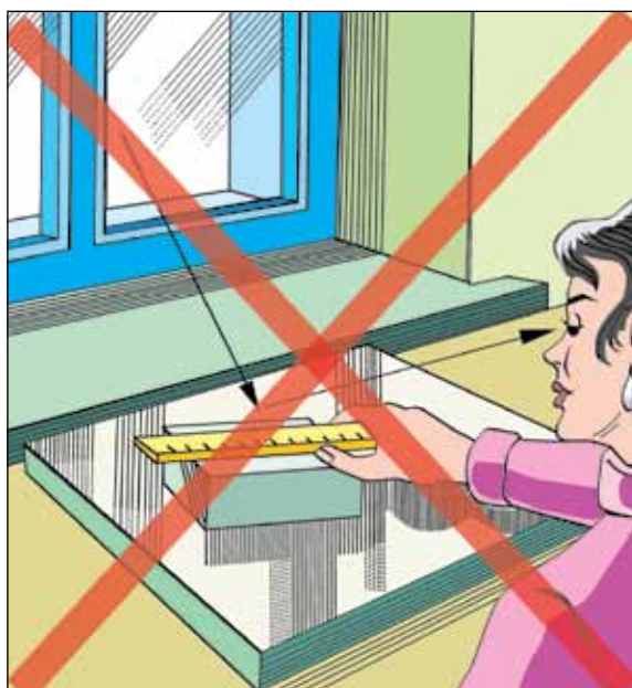
Figura 70d. Ofuscamento refletido a partir de uma superfície polida.
