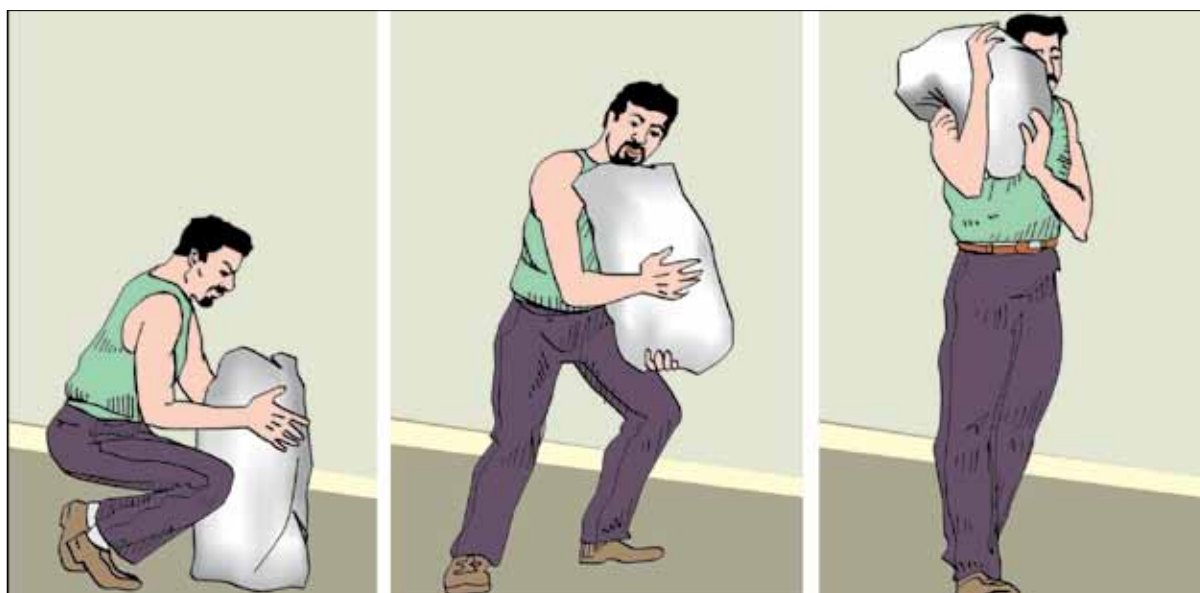
Figura 15a. Levante ou abaixe uma carga pesada diante do corpo, mantendo as costas eretas e com os pés em uma posição estável, empregando a força das pernas.
