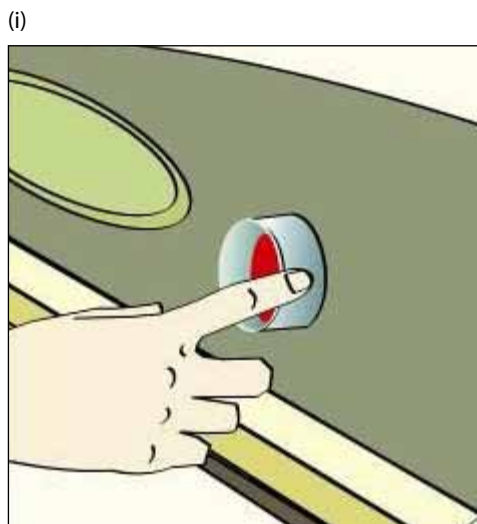
Figura 32b. (i) e (ii) Proteja os controles importantes da ativação acidental, por exemplo, providenciando uma “gaiola” ao redor de cada controle ou adicionando uma tampa transparente.
