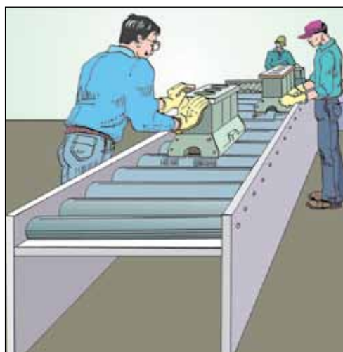
Figura 13c. Empurre e puxe os materiais pesados, em lugar de erguê-los ou baixá-los.
