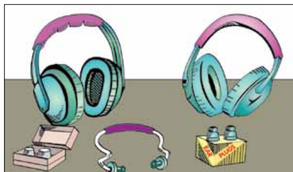
Figura 101d. Dê alta prioridade para o conforto dos trabalhadores e fácil manutenção na seleção do equipamento de proteção pessoal dentre os tipos disponíveis.
