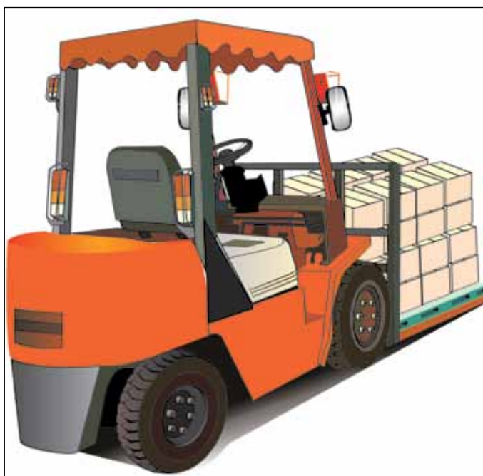
Figura 49a. Providencie suporte para aumentar o conforto de condução da empilhadeira, como um assento de absorção de vibração, espelhos, estrutura acima da cabeça e paletes adequados.
