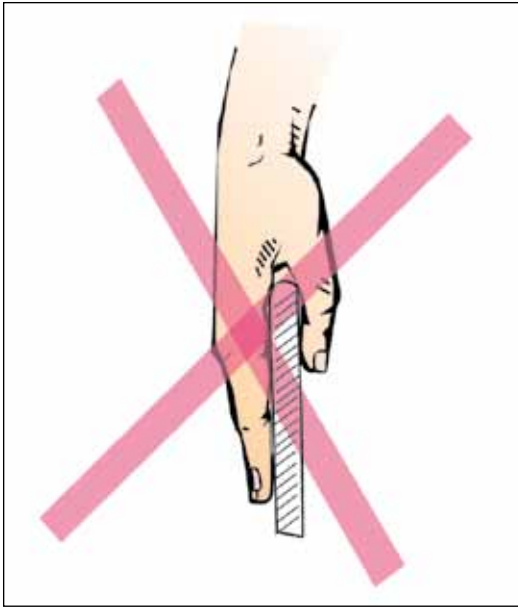
Figura 12a. Os pontos de apreensão devem estar recortados para permitir que o recipiente seja agarrado com os dedos flexionados. Isso pode reduzir bastante a força necessária para segurar o recipiente.
