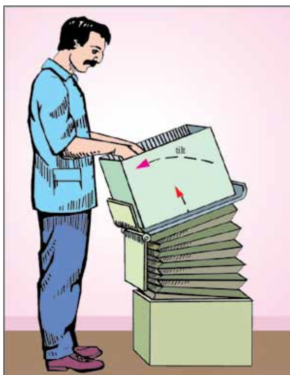
Figura 56b. Fazer o trabalho em frente ao corpo, na altura dos cotovelos ou em uma altura um pouco mais baixa é desejável. Utilize recursos de inclinação ou elevação se necessário.
