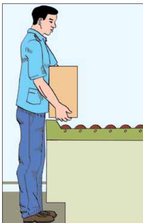
Figura 5b. Rolões ou esteiras rolantes podem reduzir a distância do movimento manual de materiais. A altura deve ser apropriada para manipular o item de trabalho sem inclinar a parte superior do corpo. Certifique-se de que haja espaço suficiente para manter-se próximo aos rolões ou esteiras rolantes e para os pés.
