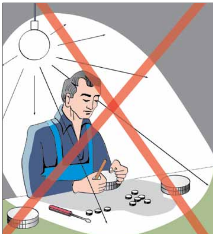
Figura 67c. As sombras escuras tornam o trabalho difícil.
