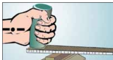
Figura 24c. Para um manejo firme e seguro da ferramenta, deve ser possível que os quatro dedos passem ao redor do cabo, permitindo que o polegar se coloque sobre o indicador.
