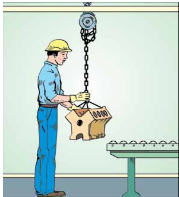
Figura 9d. Certifique-se de que a máxima carga segura esteja claramente marcada.
