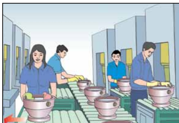
Figura 6d. Uma esteira transportadora passiva para mover peças pesadas de motores em elevações de trabalho.
