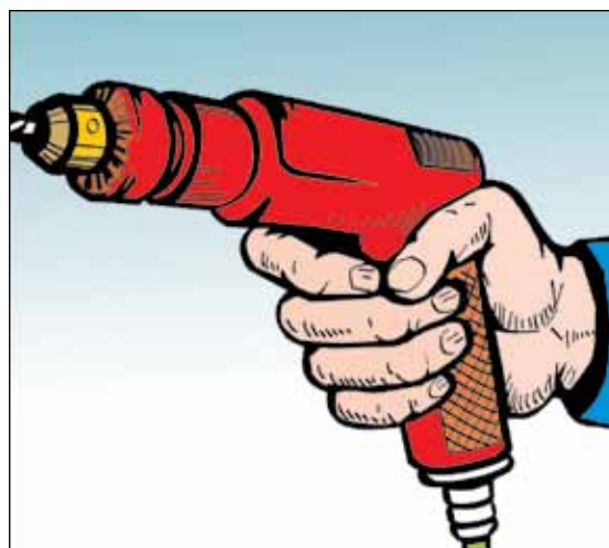
Figura 18c. (i) e (ii) Preensão constante de ferramentas mecânicas podem ajudar a reduzir a força necessária de operação.
