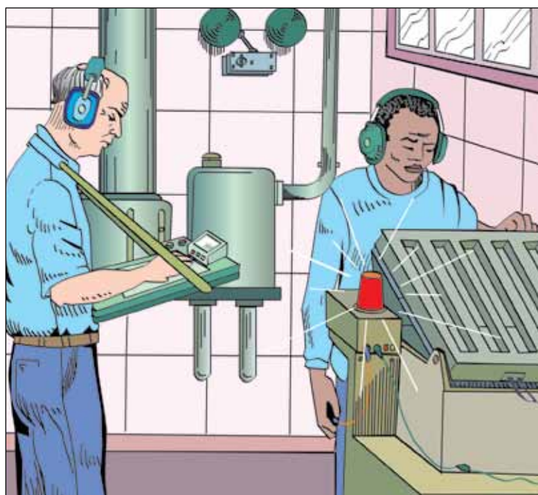
Figura 87b. Assegure a eficiência dos protetores auriculares. Eles não podem intervir na comunicação. Avisos de emergência luminosos e alarmes são meios de comunicação importantes quando os protetores auriculares estão sendo utilizados.
