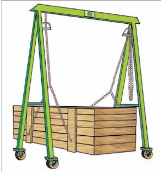
Figura 9a. Uma cábrea móvel é confiável, segura e fácil de manejar para o transporte de carga pesada a uma distância curta com mínima elevação.
