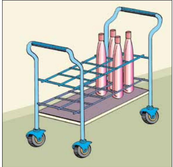
Figura 7c. Carrinho auxiliar projetado especialmente para a armazenagem e manipulação de silenciadores de bicicleta.
